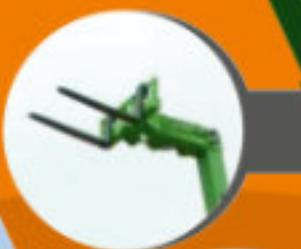
Hydraulicky roztažitelné paletizační vidle s nosností 4t
